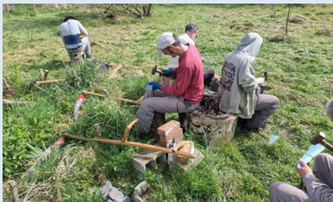
Apprentissage du battage de la lame.
